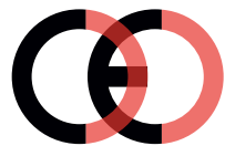
Falsk CE-mærke (for tæt på hinanden)
